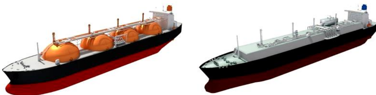
Figura 105 - Navio tipo LNGC tipo Moss e navio LNGC tipo Membrana, respectivamente.
