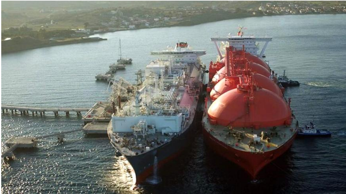
Figura 108 - Navio FSRU atracado em Pier tipo ilha, com navio LNGC tipo Moss atracado a contrabordo. (Excelerate Energy, 2023).
