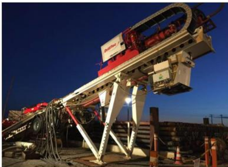
Figura 97 - Perfuratriz direcional horizontal.
