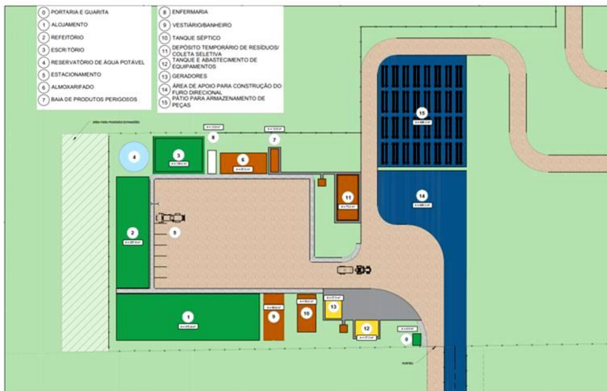
Figura 85 - Layout do canteiro de obras.
