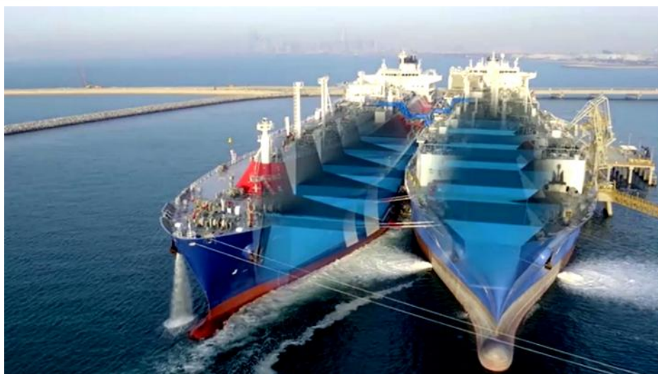
Figura 107 - Exemplo esquemático de transferência de GNL ship-to-ship . (Excelerate Energy, 2023).
