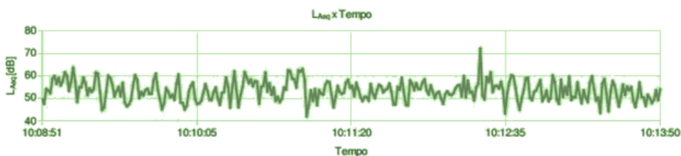
Figura 39 - Gráfico de medição do nível de pressão sonora do ponto 02.
