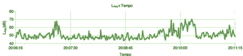
Figura 50 - Gráfico 1 - Gráfico de medição do nível de pressão sonora do ponto 03.
