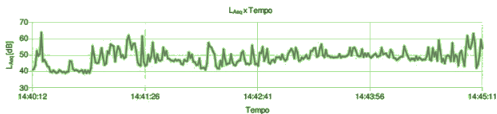
Figura 47 - Gráfico de medição do nível de pressão sonora do ponto 10.
