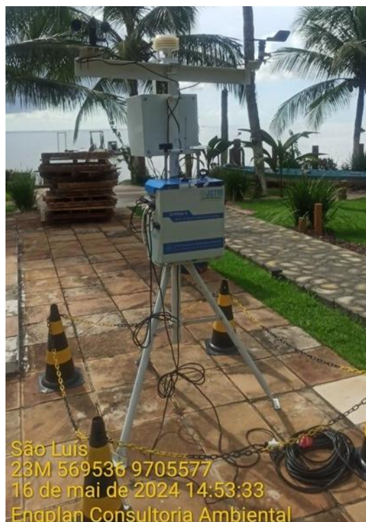
Foto 27 - Estação de Monitoramento de Qualidade do Ar modelo ECMQAr-3 utilizada no presente estudo. Fonte: Engplan (2024).
