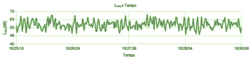
Figura 53 - Gráfico de medição do nível de pressão sonora do ponto 06.
