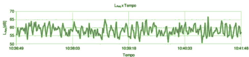
Figura 43 - Gráfico de medição do nível de pressão sonora do ponto 06.
