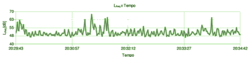
Figura 48 - Gráfico de medição do nível de pressão sonora do ponto 01.
