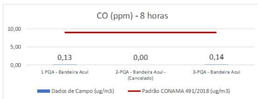
Figura 30 - Monóxido de Carbono (CO) 8 horas (máxima média móvel obtida nos pontos abordados). Fonte: Engplan (2024).
