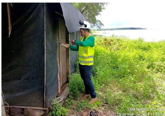
Foto 63 - Medição de vibração no ponto 08 - diurna.
