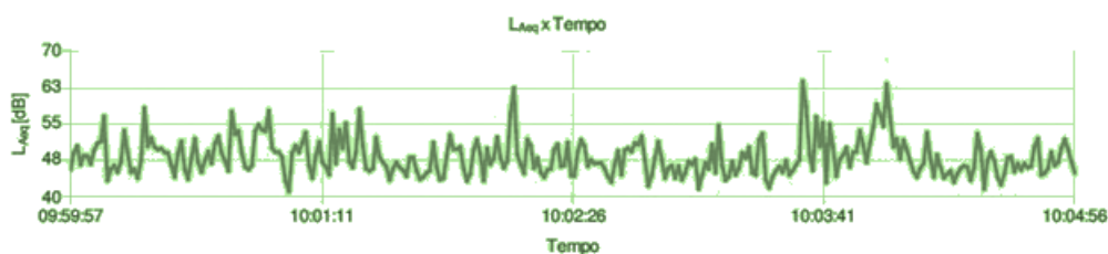
Figura 38 - Gráfico de medição do nível de pressão sonora do ponto 01.
