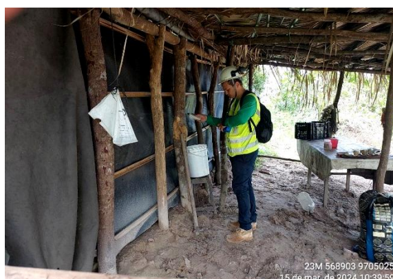
Foto 59 - Medição de vibração no ponto 06 - diurna.
